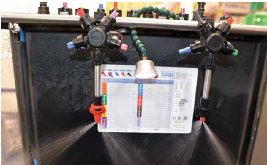
Porównanie pracy inżektorowych rozpylaczy dwustrumieniowych (Lechler) – z lewej asymetryczny IDTA (Agritechnica 2015).
